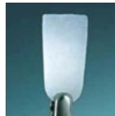
Abb 2: Brennprobe bei zu niedriger Brenntemperatur
