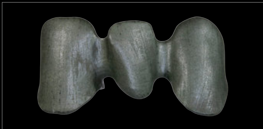
Abb. 10 Bei 950°C 1 Minute unter Vakuum brennen.
