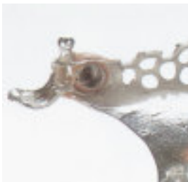
Abb. 51: Achten Sie darauf, dass das Flussmittel um die Gewindekappe geflossen ist.
