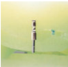
Abb. 28: Schrauben Sie die Gewindekappe von der Patrizе und drehen Sie die Fixierschraube ein. Brühen Sie eventuell in die Gewindekappe geflossene Wachsreste aus, da sonst beim Guss Metall einfließen kann.
