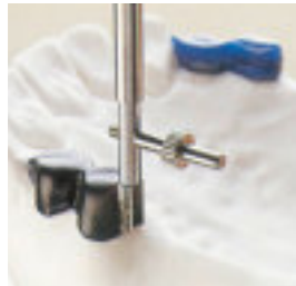
Abb. 11: Nach Festlegen der Einschubrichtung setzen Sie die Metallmatrize mit Parallelometer und Parallelhalter REF 5151 an die Kronenwand.
