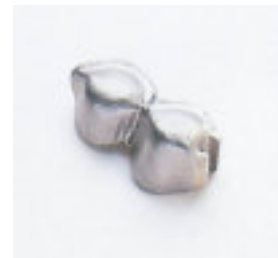
Abb. 24: Arbeiten Sie die Lotstelle aus. Vergüten Sie die Geschiebematrize in einem Ofen (0-700°C, 30 Minuten halten, langsam abkühlen lassen).
