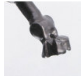
Abb. 20: Nach dem Ausarbeiten des Gussobjektes arbeiten Sie die Matrizenaufnahme in der Kronenwand nach.
