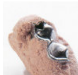
Abb. 23: Erstellen Sie einen Lötblock und löten Sie wie gewohnt. Wurde das Geschiebe angepunktet, schützen Sie die Matrizeninnenflächen mit Antiflussmittel.
