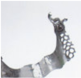
Abb. 47: Die Gewindekappe muss nach dem Fixieren bewegungslos mit der Modellgussbasis verbunden sein.
