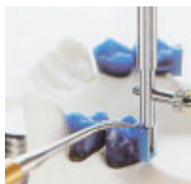
Abb. 4: Setzen Sie die Matrize an die Kronenwand bzw. in die Aussparung und wachsen Sie die Matrize an.
