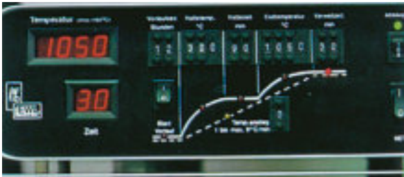
Abb. 38: Um ein zu starkes Oxydieren der Fixierschraube zu vermeiden, sollte die Endtemperatur (950-1050°C) nicht länger als 30 Minuten auf die Muffel einwirken.
