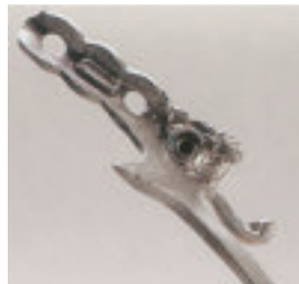
Abb. 40: Säubern Sie den Boden der Gewindekappe mit dem Spezialinstrument REF 5153 von den evtl. noch anhaftenden Einbettmasse-Resten. Benutzen Sie Öl als Gleitmittel.
