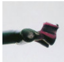
Abb. 19: Bringen Sie die Gusskanäle nach den Vorschriften der Metallhersteller an, betten Sie ein und gießen, wie gewohnt.
