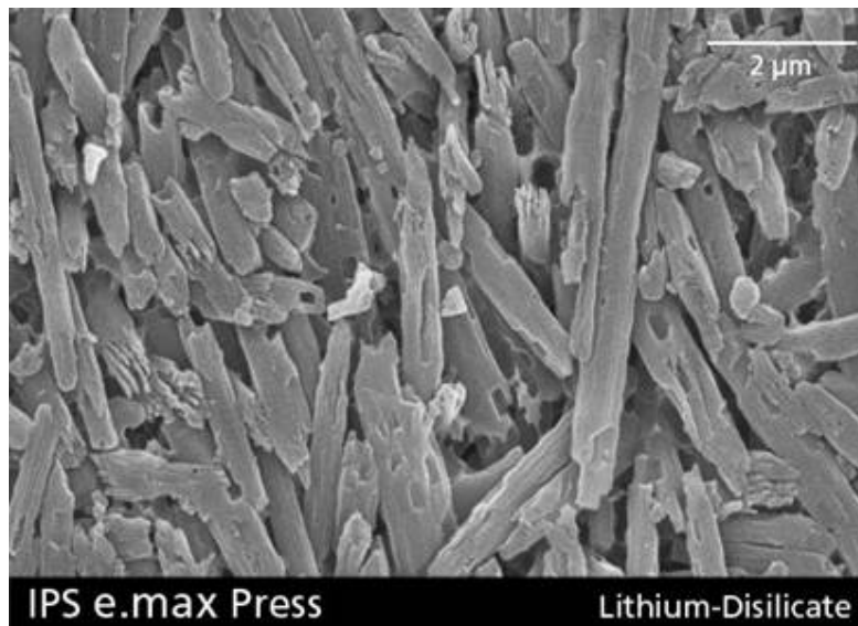
Abb. 3: Gefüge von IPS e.max Press (REM, geätzt in HF-Dampf 30 s)
